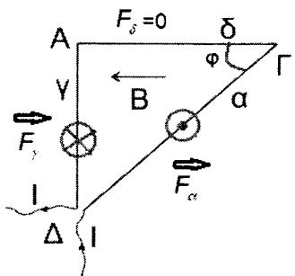
$$F_\alpha = B \cdot I \cdot \alpha \cdot \eta\mu\varphi = B \cdot I \cdot \alpha \cdot \frac{\gamma}{\alpha} = B \cdot I \cdot \gamma \quad (1)$$
